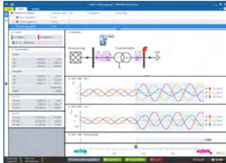
Abb. 7 Systembasierte Prüfung einer Überstromschutzfunktion in einem Diff-Schutzgerät durch Simulation eines externen Fehlers
