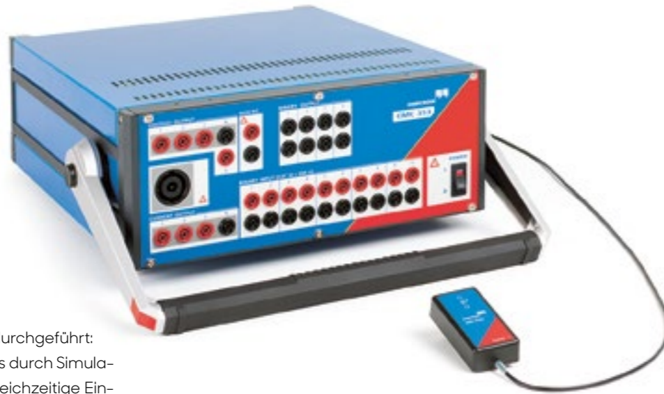
Abb. 1. Mit einer speziell für die Simulation von Lichtbögen entwickelten Auslöse-Einrichtung lassen sich Lichtbogenschutzsysteme auf einfache Weise prüfen.
