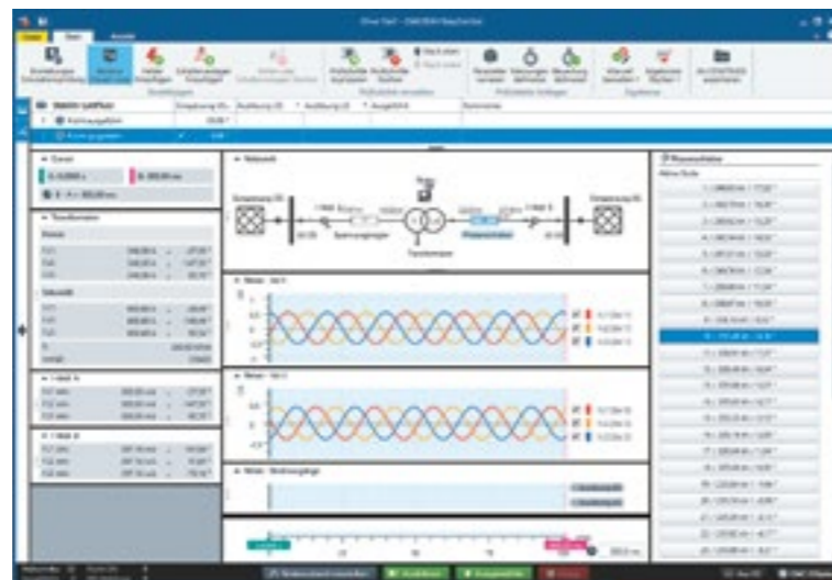
Abb. 7 Simulation eines Phasenschieber-Transformators →
