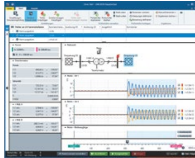
Abb. 3 Stromverlauf eines außenliegenden zweipoligen Fehlers
