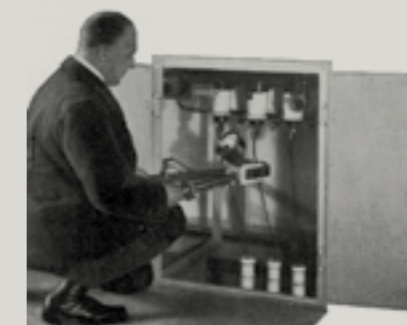
← Abb. 5 Strommessung mit Dietze-Anleger
