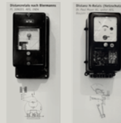
Abb. 2 Erste Impedanzrelais, Biermannsrelais, AEG und N-Relais, Dr. Paul Meyer AG, beide 1924
